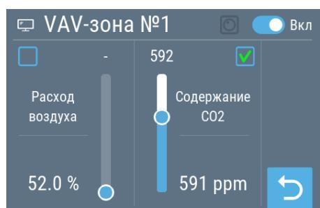
Левый ползунок позволяет задать расход воздуха, который будет автоматически поддерживаться. Расход воздуха задается в процентах, либо в  $\text{м}^3/\text{ч}$  (задается при сервисной настройке VAV-системы). Правый ползунок позволяет задать желаемое значение параметра, который измеряет датчик, – это значение будет поддерживаться путем изменения расхода воздуха в зоне.
