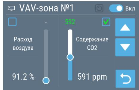
Если к зоне не подключен датчик, то VAV-зона работает только по процентному расходу и ползунок задания параметра становится неактивным.
