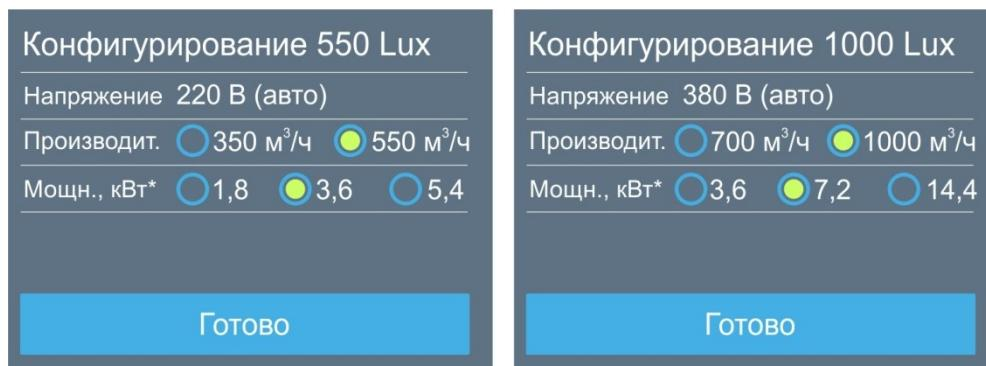
Напряжение питания калорифера (380В – 3 фазы или 220В – 1 фаза) устанавливается автоматически в зависимости от типа электропитания вентустановки.
