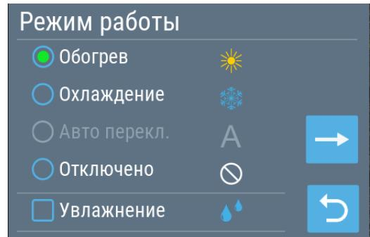
Отдельно включается режим **«Увлажнение»** (при наличии увлажнителя) для поддержания заданной влажности воздуха. При включении этого режима на основном экране появляется соответствующая пиктограмма.
