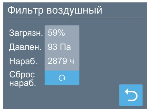
Второй параметр – падение давления на фильтре, измеренное датчиком (зависит от загрязненности фильтра и скорости вентилятора). Третий параметр – время наработки воздушного фильтра, которое рассчитывается исходя из времени работы вентустановки и скорости вентилятора (на низких скоростях вентилятора загрязнение происходит медленнее). Это справочный параметр, который на работу вентустановки не влияет. При замене фильтра рекомендуется инициировать счетчик, нажав кнопку «Сброс наработки».
