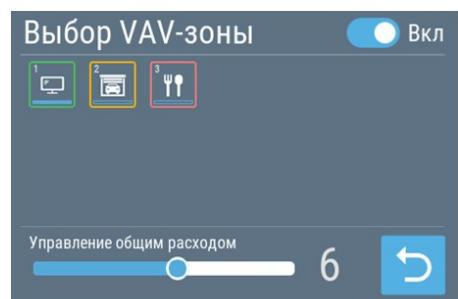
Ползунком «Управление общим расходом» пользователь может снижать поддерживаемое давление, уменьшая, тем самым, общий расход воздуха. Эта функция по умолчанию отключена, поскольку снижение давления может привести к разбалансировке VAV-системы. Разрешить или запретить управление общим расходом можно в сервисных настройках.
